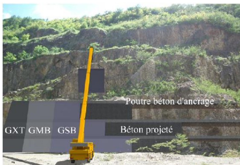
Figure 4. Schéma conceptuel de la pose des géosynthétiques sur le parement
