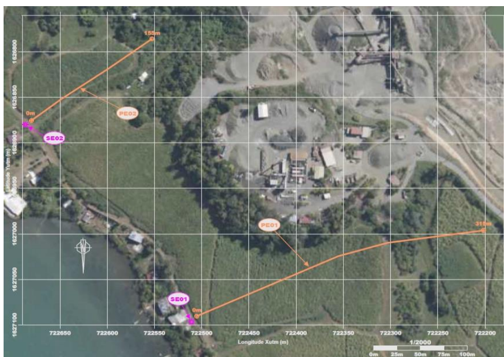
Figure 6. Sondages électriques notés SE01 et SE02 (AB/2 de 140 m) ainsi que 2 panneaux électriques PE01 et PE02 respectivement de 315 m et de 155 m
